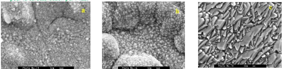
**Fig.4. Les images MEB des échantillons de Cu<sub>2</sub>O électrodéposés sur de l'acier à des pH (a) 7,0, (b) 9, et (c) 12,0.**
