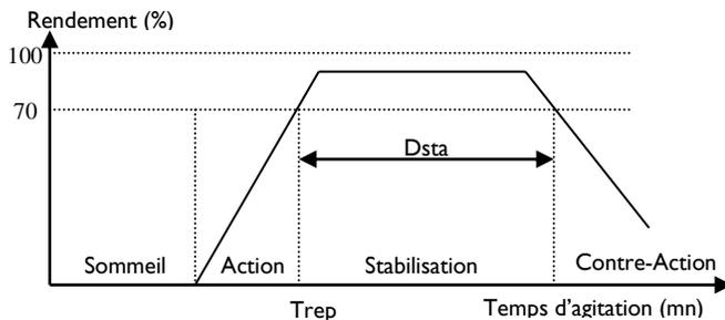
Fig.1. Allure typique de la courbe du rendement d'extraction.
