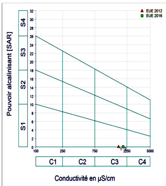
Fig. I6- Diagramme du SAR des eaux épurées (STEP, Khenchela).
