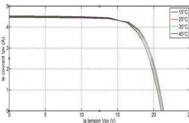
Figure 5. Caractéristique I-V du module PV selon la température.
