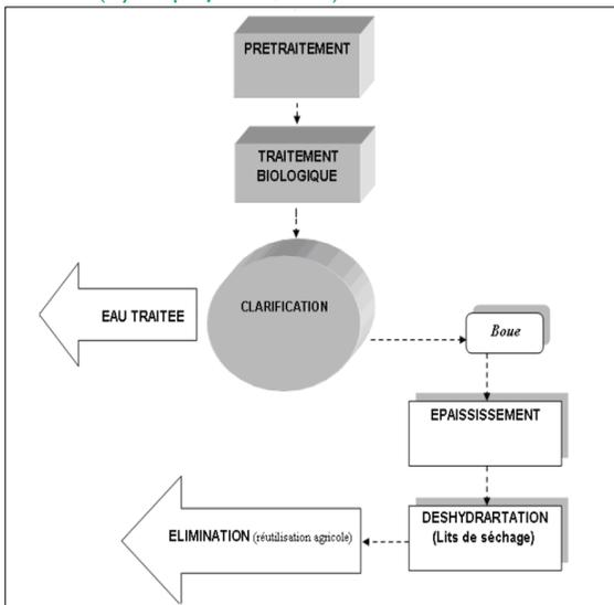
**Fig.02-** Schéma général de la filière de traitement des eaux usées de la STEP de Khenchela (Djeddu, 2014)
