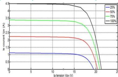
Fig.3: Caractéristique I-V du module PV selon l'éclairement
