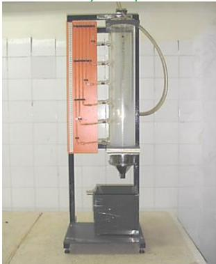
**Figure 1** – Banc d'essai ou appareil de DARCY.
