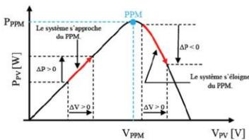
Fig. 7 : Caractéristique puissance–tension d'un panneau photovoltaïque [6].
