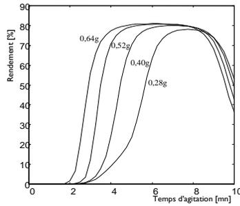
Fig.7- Influence de la masse du tensioactif  $m_t$  sur le rendement d'extraction.
