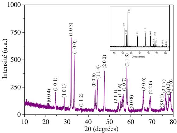
Figure 1. DRX de La<sub>2</sub>NiO<sub>4</sub> synthétisé par voie sol gel (insert DRX de ZnO)
