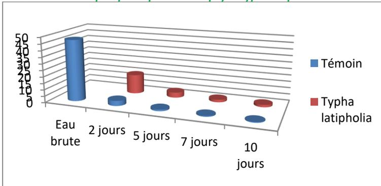
**Fig. 4 – Elimination du phosphore par *Typha latifolia***
