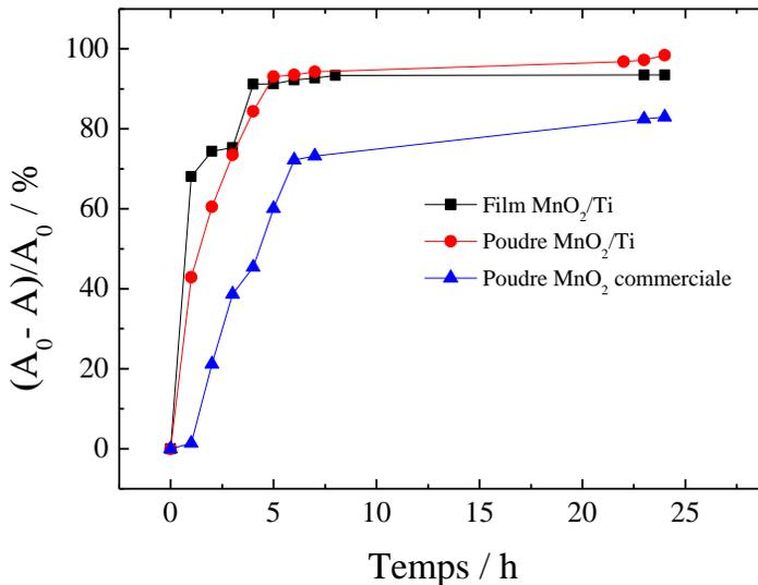
Figure 3 : Taux de décoloration du BM en fonction du temps par un film MnO<sub>2</sub>/Ti et des poudres de MnO<sub>2</sub>/Ti et MnO<sub>2</sub> commerciale. Concentration initiale en BM (6,25 μM), pH 1,8.
