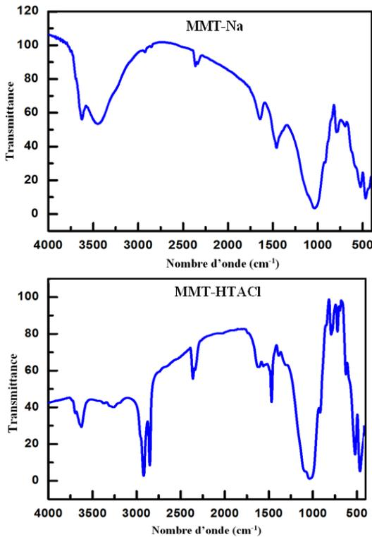
Fig. 2 - Spectre IR de MMT-Na et MMT-HTACl.
