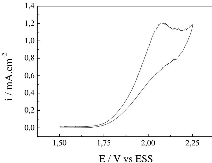
Figure 1 : Courbe de voltampérométrie cyclique sur une électrode de titane.  $MnSO_4 \cdot H_2O$  (0,3M), pH 1,8,  $V_b = 10$  mV/s et  $T = 21 \pm 1$  °C.
