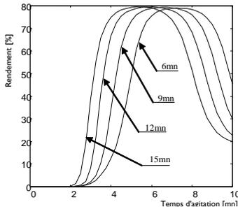
Fig.6- Influence du temps d'émulsification  $t_{em}$  sur le rendement d'extraction.
