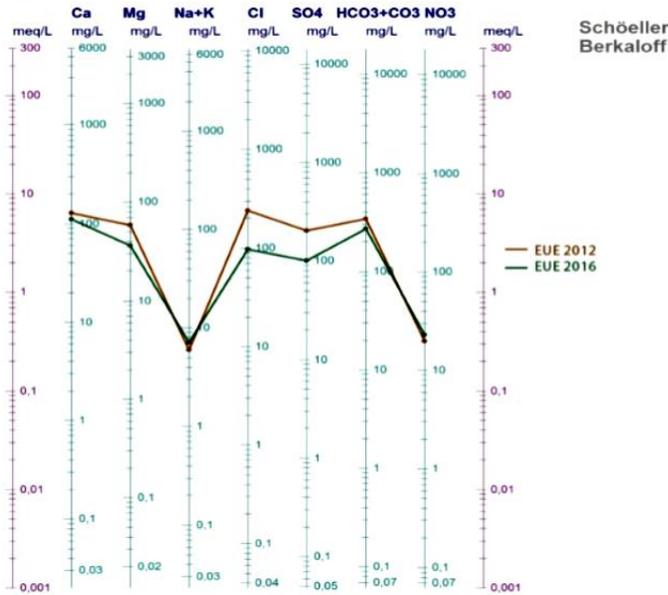
Fig.14- Diagramme de Schoeller Berkalfol des eaux épurées de la STEP (Khenchela)
