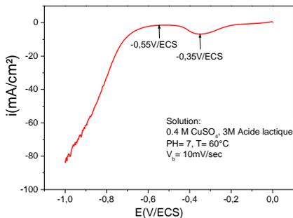
Fig. 2. Courbe de voltampérométrie cyclique pour une solution contenant 0,4 M de CuSO<sub>4</sub> et 3 M d'acide lactique (pH = 7, T = 60 °C).
