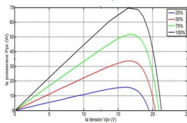
Fig. 4. Caractéristique P-V du module PV selon l'éclairement.
