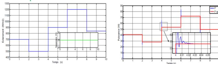
Fig.9 : Variation de l'éclairement et la température. Fig.10 : Allure de puissance P et Pop.
