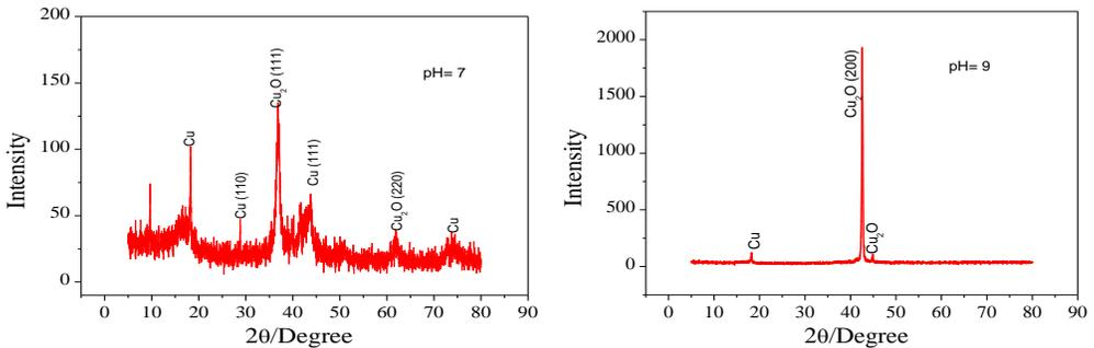
**Fig.3. diagrammes DRX des films d'oxyde cuivreux: à pH = 7,0 et pH = 9,0.**
