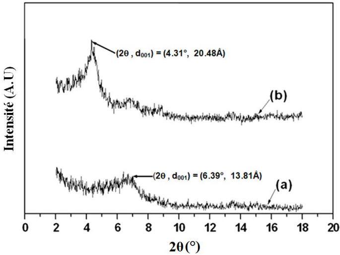
Fig. 3 - Diffractogramme RX de : (a) MMT-Na, (b) OMMT.
