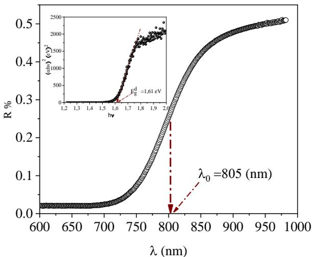
Figure 2. Le spectre de réflectance diffuse de La<sub>2</sub>NiO<sub>4</sub>. (Insert la transition optique).
