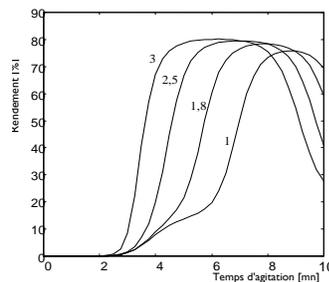
Fig.5- Influence du rapport  $V_{org}/V_{in}$  sur le rendement d'extraction.
