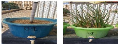
Fig. 1 - Filtre nu Fig. 2-Filtre planté
