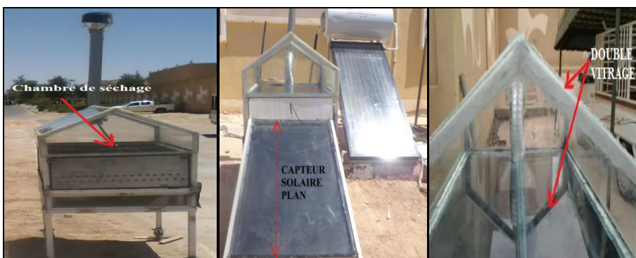
Figure 1 : Séchoir solaire directe (mode I) et capteur solaire plan connecté au séchoir solaire (mode amélioré)
