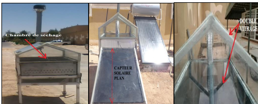
Figure 1 : Sechoir solaire directe (mode I) et capteur solaire plan connecté au séchoir solaire (mode amélioré)
