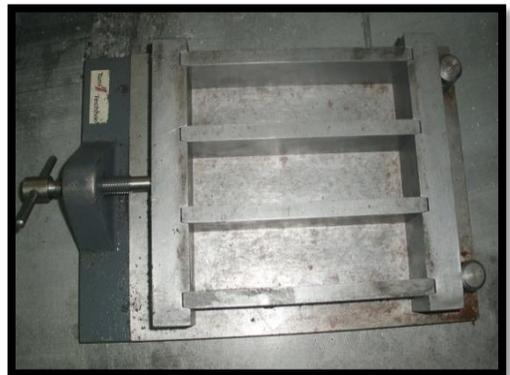
Le moule remplie de mortier est conservé dans une armoire humide (98%) et à une température de  $20\text{ }^{\circ}\text{C} \pm 2$  et sans empilage les uns sur les autres.
