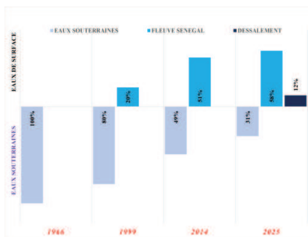
Fig. 4 — Évolution des sources d'eau alimentant la région de Dakar de 1966 à 2025 (Sources de données diverses dont Descroix et Esteves (2005), H2O ENGINEERING (2016), SONES (2020) et Office des lacs et cours d'eau (2020).
