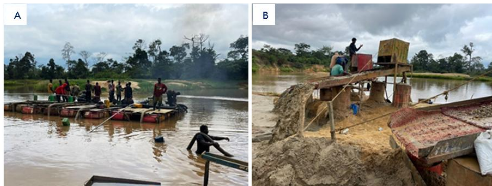
Figure 5 : Exploitation artisanale de l'or à l'aide de barques fixes avec des plongeurs sur le fleuve Cavally : A = extraction du minéral ; B = lavage du minéral.
