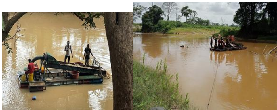
Figure 7 : Exploitation par dragage à l'aide de barque mobile sur le fleuve Cavally
